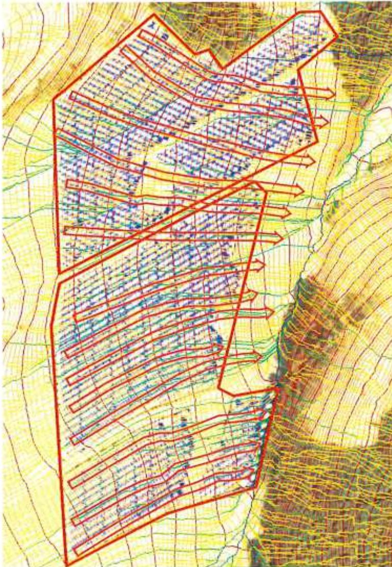
Aufständigung Modulreihen: Höhenlinien aus DGM1 (mit flow accumulation); voraussichtliche Fließwege bei Starkregen (rote Pfeile)
